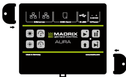
**2x Wandhalterungen:** Stecken Sie je einen Halter in die vorgefertigten Löcher auf der linken und rechten Seite. Sichern Sie das montierte Gerät nur auf festen Untergründen mit Schrauben  $\varnothing = 3,5$  mm.
