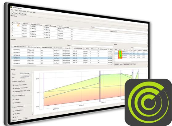
Auf der einen Seite bietet ein neuer Bereich einen Überblick über alle verbundenen Art-Net-Nodes. Die Software zeigt auf einen Blick an, wenn ein Verbindungsabbruch erkannt wurde. Große Medienfassaden sind eines der Hauptanwendungsgebiete von RADAR. Es ist zum Beispiel extrem hilfreich zu wissen, ob 50 Lampen ausgetauscht werden müssen oder zunächst nur ein einzelner Controller überprüft werden sollte.
